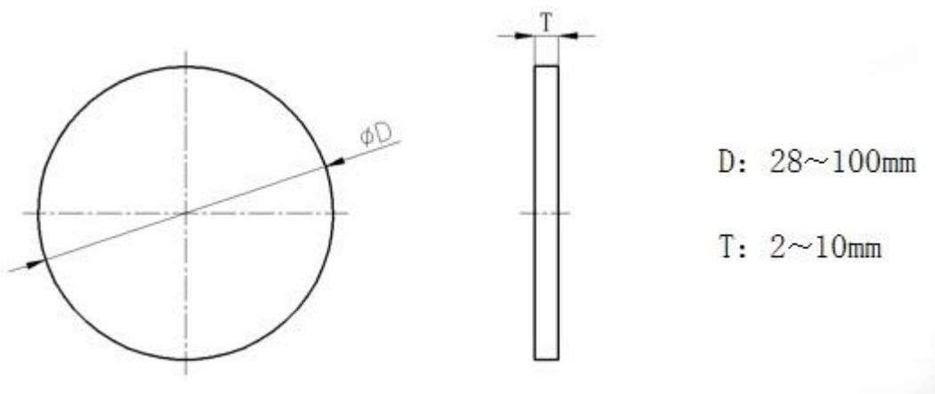
Materiale: substrati di carburo per PDC possono essere forniti materiali di corrispondenza in base alle necessità del cliente.
