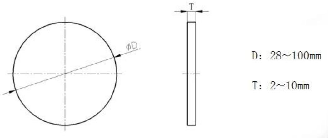
Material: Substratos de Carbetos Para PDC podem ser fornecidos materiais correspondentes de acordo com a necessidade do cliente.
